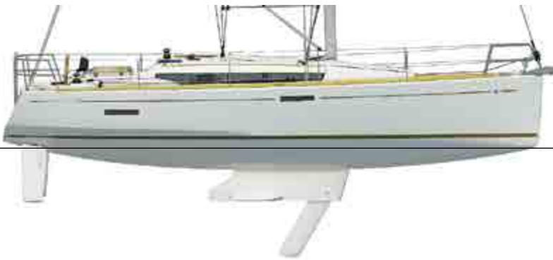
Advanced winged keel design for shoal draft version Quille optimisée, à ailettes, pour la version PTE Fortschrittliches Flügelkiel Design für Kurzkielversion Quilla corta optimizada con aletas Chiglia ottimizzata, con alette, per la versione ridotta
